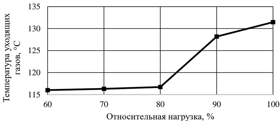
Рис. 3. Зависимость температуры уходящих газов от нагрузки
