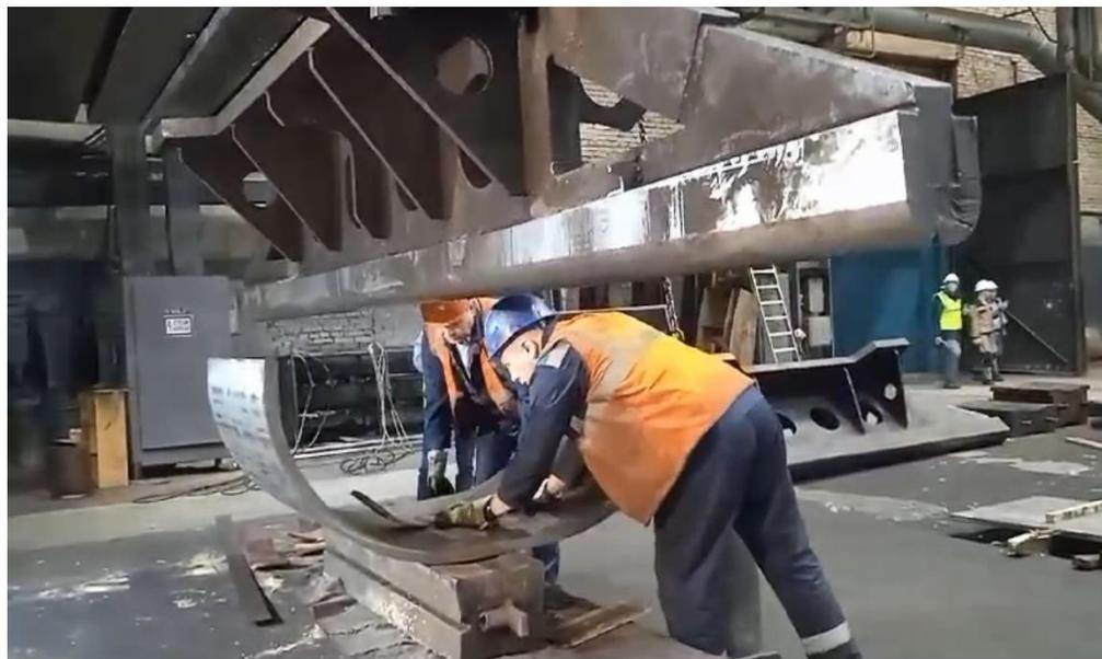
Рис. 1. Процесс гибки детали «Полуцилиндр»
