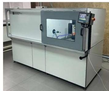
Рис. 1. Схема (а) и внешний вид установки LS85 (б) для проведения процесса лазерной ударной обработки
